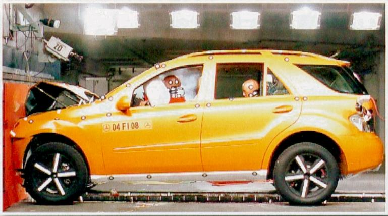
Die Sekunde null: Ungebremst rast das Versuchsfahrzeug mit 64 km/h in die künstliche Barriere. Dummys halten anstelle der Insassen ihren Kopf hin
